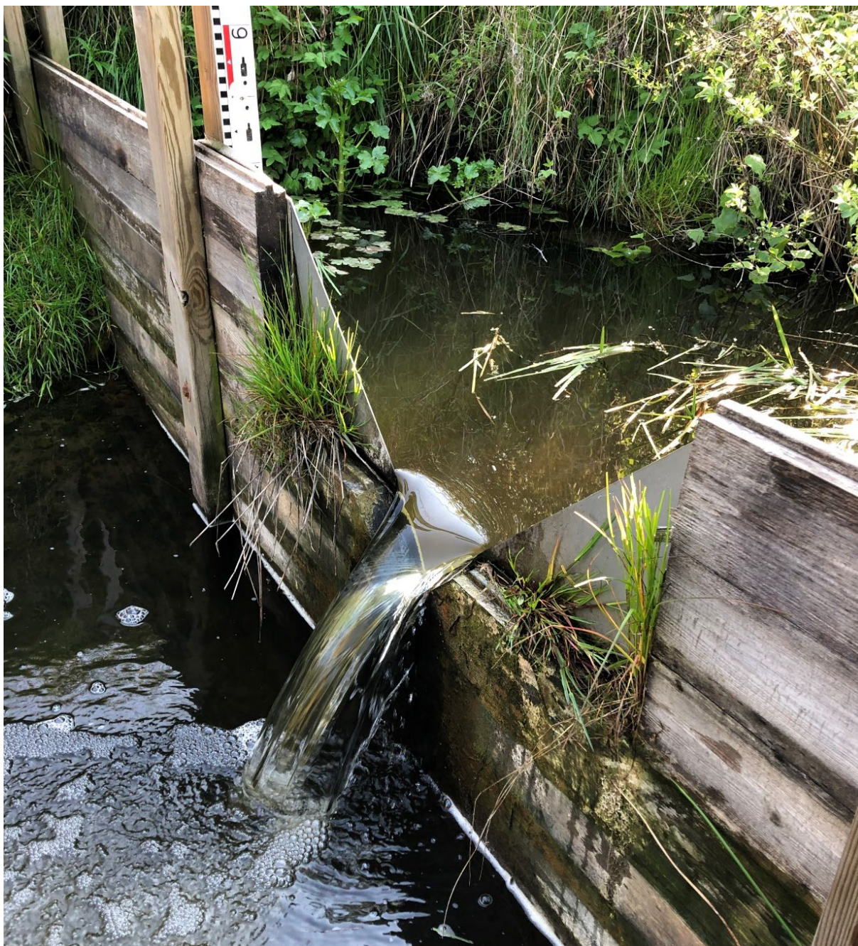
Figur 2.2.2:1. Vattenflöde över ett v-format mätöverfall. Bild från Påboda utlopp 2019-05-20.
