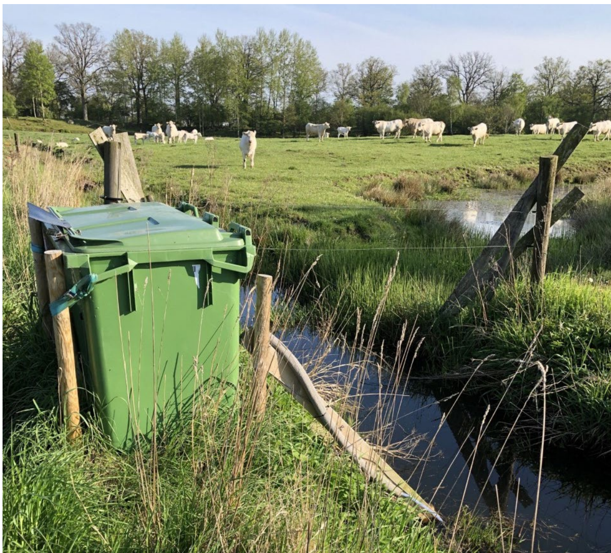
Figur 2.2.1:2. Provtagare placerad inuti sopkärl för skydd mot väder, vind och annan yttre påverkan från exempelvis nötkreatur. Bild från Hossmo inlopp 2019-05-20.
