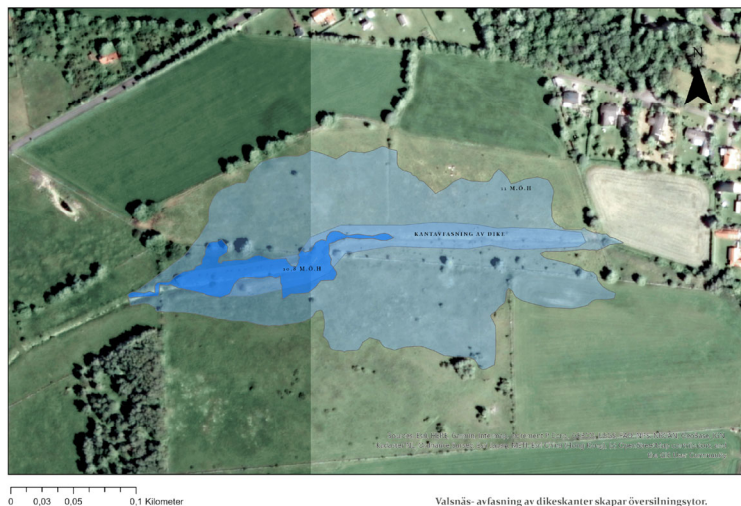
Figur 11. Övrebild: Bilden visar det raka diket i Valsnäs och den torra beteshagen det skär igenom. Augusti 2020. Nedrebild: Kantavfasning och borttagning av dikesvallar i beteshage skapar en tillfällig våtmark i en naturlig topografisk sänka.
