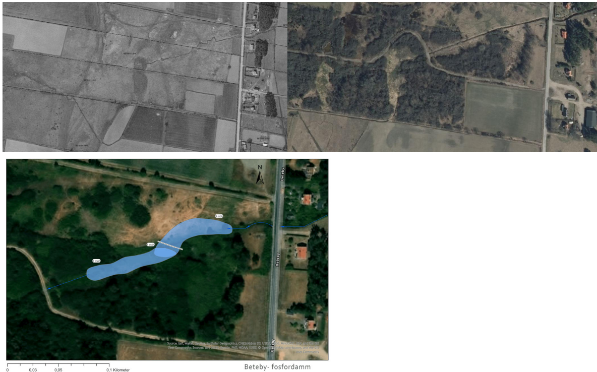
Figur 13. Övre bild vänster: Flygfoto från 1970-tal som visar hur vattnet rörde sig innan nya diken drog över området. Överbild höger: Flygfoto från 2013 visar vart vattnet rinner idag. Nedre bild: Åtgärdsförslag: en långsmal fosfordamm bromsar upp vattnet på vägen.
